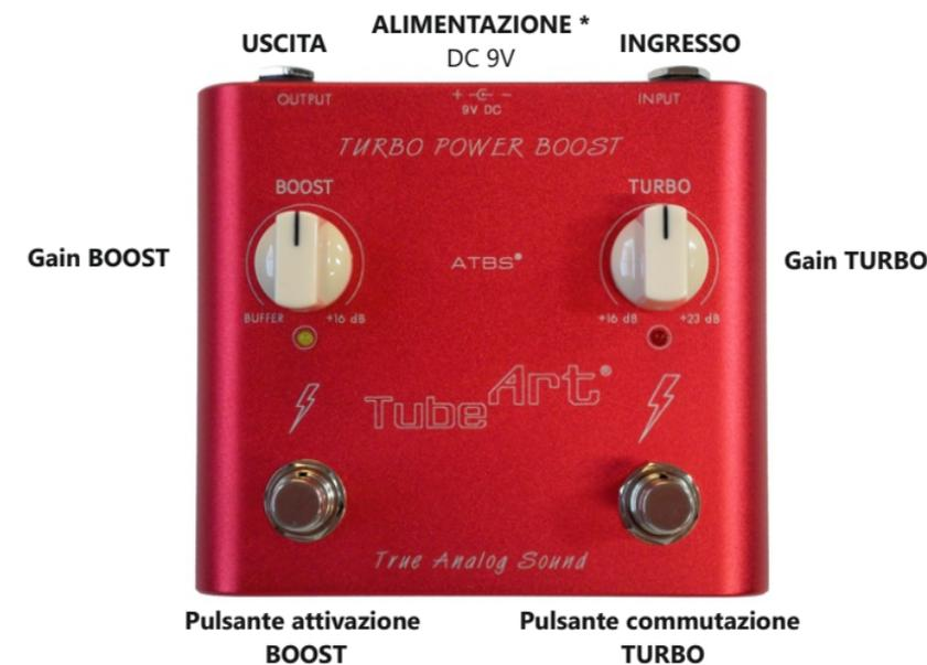
\* **ALIMENTAZIONE:** Assicurarsi che l'alimentatore impiegato abbia un connettore con polo positivo (+) esterno. Le dimensioni del connettore sono standard, ovvero 2.1mm (pin interno) e 5.5 mm (diametro esterno). Verificare che la corrente disponibile sia sufficiente a coprire la corrente di assorbimento del Turbo Power Boost, come da descrizione sul retro del pedale.
